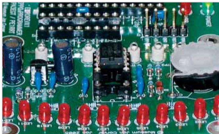
Fig. 5 PIC-processor in extra voetje om beschadiging te voorkomen
